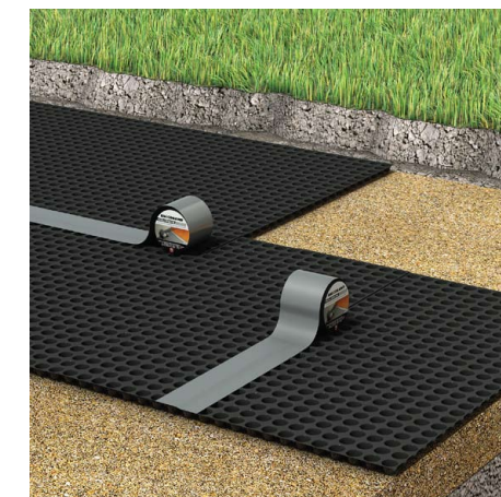
3. Скрепление нахлестов может быть выполнено по трем вариантам: «сухой»; с проклейкой самоклеящейся лентой PLANTERBAND или PLANTERBAND DUO; точечное скрепление беглой сваркой при помощи строительного фена.
